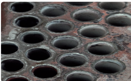
Les échangeurs de chaleur traditionnels s'encrassent rapidement, réduisant l'efficacité et entraînant une augmentation de la consommation énergétique.
